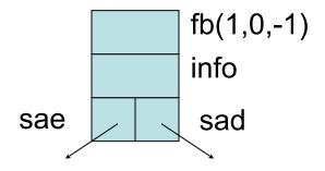
Não há necessidade de armazenar a altura, apenas a diferença de altura, ou seja, o fator de balanceamento (fb), que tem que ser modificado no caminho de inserção, mesmo se não sejam realizadas rotações
